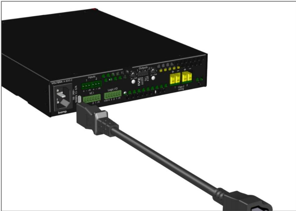
1. 電源コードをアンプ背面の電源レセプタクルに接続します。
