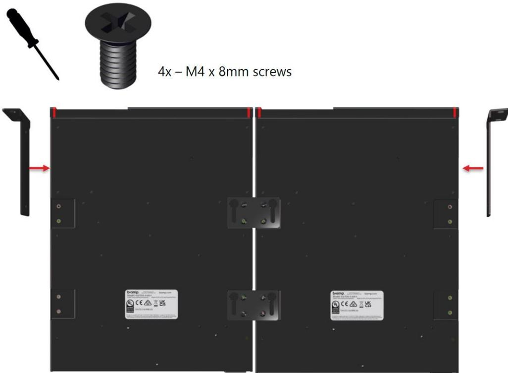
4. 付属のデバイスマウントブラケットを1台目のアンプの左側に固定します。
