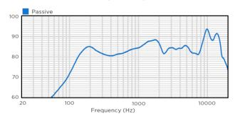
・水平軸外 レスポンス (dB) HORIZONTAL OFF-AXIS RESPONSE (dB)
