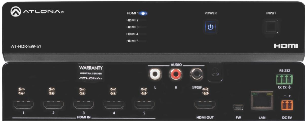
AT-HDR-SW-51 は HDR（ハイダイナミックレンジ）フォーマット対応の 5×1 HDMI スイッチャーです。本製品は HDCP 2.2 に適合し、4K/UHD（60 Hz 4:4:4）および最大 18 Gbps の HDMI データに対応。4K/UHD や HDR 対応ソースを使用するディスプレイに最適です。また、EDID マネジメント機能や自動入力切り替え機能を搭載し、4K 信号を 1080p（60 Hz / 30 Hz / 24 Hz）にダウンスケールすることも可能です。さらに、HDMI 入力のオーディオを S/PDIF またはアナログオーディオ出力にディエンベッドできます。イーサネット、RS-232、赤外線に対応し、さまざまな環境で制御が可能です。
