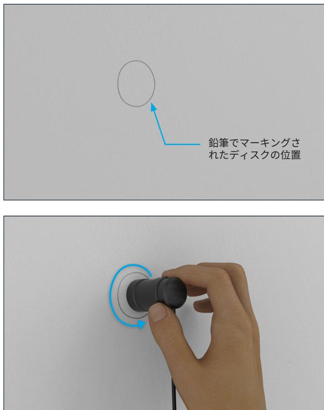
図4：マークしたディスクの位置を中心に、プローブをゆっくりと周回させる。
