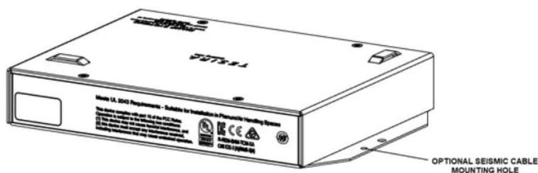
図4 TCM-X 耐震ケーブルの取り付け
