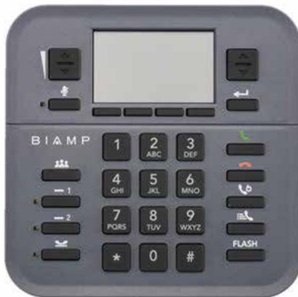
Tesira HD-1 は、Tesira サーバークラスデバイス用のハードウェアダイヤラーです。Tesira と互換性があり、STC-2 または SVC-2 カードがインストールされた SERVER および SERVER-IO のほか、TesiraFORTÉTI、TesiraFORTÉVI、TesiraFORTÉAVB TI、TesiraFORTÉAVB VI で使用可能です。
